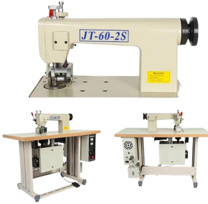
شكل رقم (4) يوضح الحياكة بالموجات فوق الصوتية عن طريق اللحام (Welding Ultrasonic)
